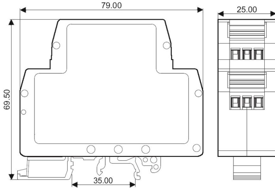
可以安装在标准 DIN35 导轨上
