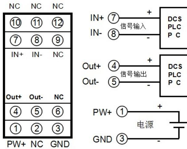
图3 WJ100 模块接线图
